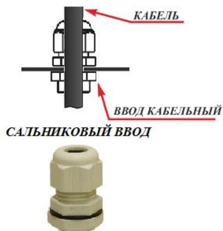
Рисунок 3.1 – Механическое крепление внешних кабелей
